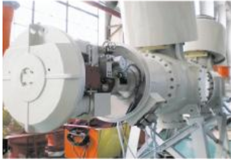
图 1 HDA-3 液压机构配 LW56-363 型断路器
